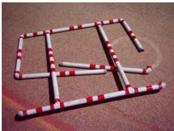
*Début du démontage: tous les tubes sont juste emboîtés. La tige au premier plan est normalement en hauteur, et doit être relié au reste avec le tube et le raccord à 90° (encore sur attaché à la base à gauche, séparé à droite).*
