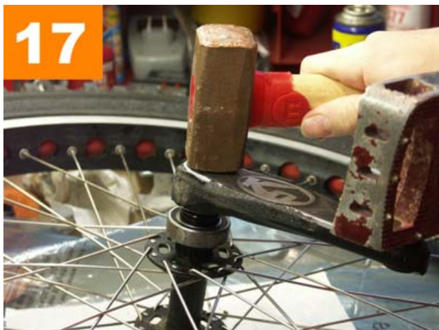
Image 17 Tapez le centre de votre manivelle avec un maillet, le côté opposé de l'axe sur un support solide (évitiez la table du salon !).
