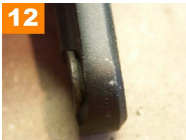
Image 12 Au passage, vérifiez vos manivelles ! Si l'insert de la pédale est sorti, renfoncez-le avec un maillet.
