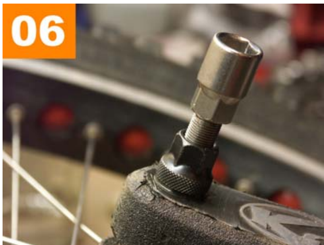
Image 6 Insérez l'arrache-manivelle. Attention, vérifiez que vous vissez bien dans l'axe !! Si vous partez de travers, vous détruirez votre filetage !!
