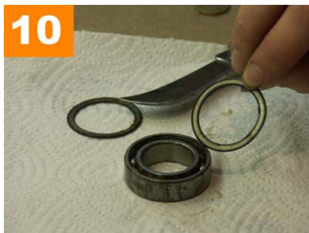
Image 10 Démontez les flasques du roulement avec un couteau, sans les abîmer. Si ceux-ci sont métalliques, il y a un petit circlip. Enlevez-le avec une pointe d'aiguille.
