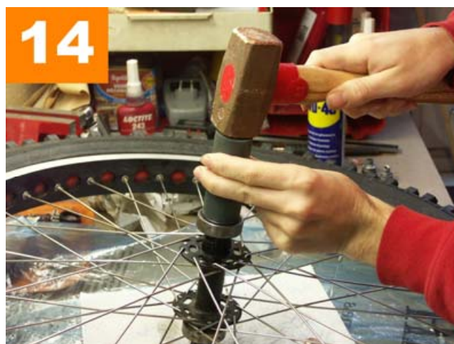
Image 14 Prenez un tube du diamètre intérieur de votre roulement pour l'enfoncer. Attention !! N'appuyez JAMAIS sur l'extérieur du roulement, au risque de l'abîmer immédiatement !!
