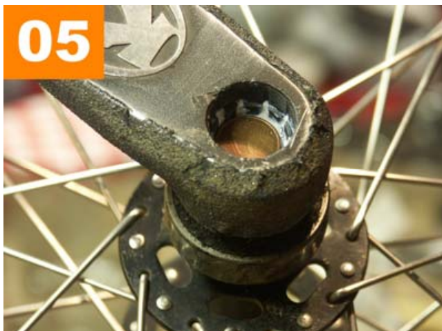
Image 5 Pour les axes creux (ici un Kox-one ISIS), placez DEUX pièces de 1 centime (une seule se déforme) au centre de l'axe.
