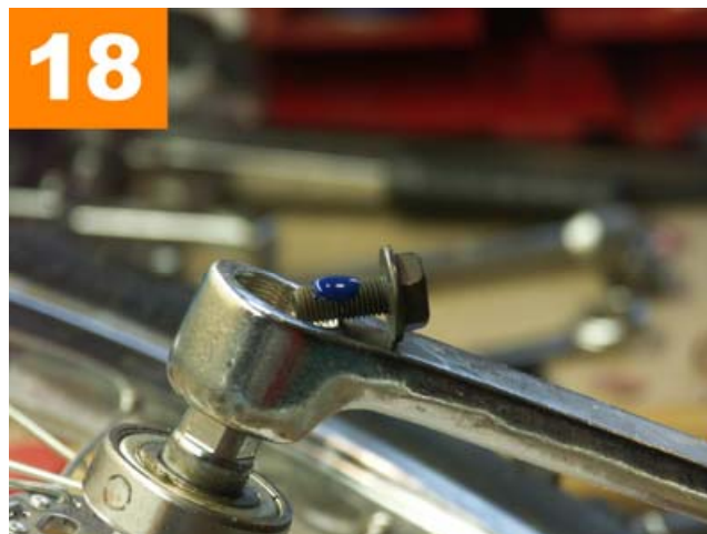
Image 18 Avant de remonter le boulon, mettez une goutte de frein filet dessus pour éviter qu'il ne se desserre.
