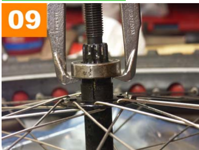
Image 9 Serrez l'arrache-roulement jusqu'à décrocher le roulement. Le plus dur est fait !
