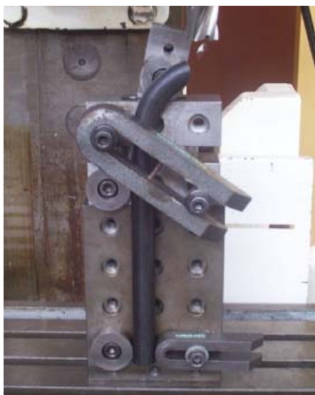
Ci-dessus : Cintrage de fourche Ci-contre : Contrôle de l'axe
