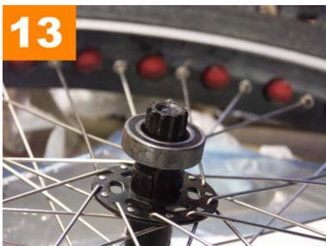
Image 13 Une fois vos roulements propres et graissés, remettez-les sur l'axe, sans graisse.
