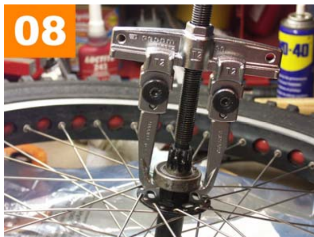
Image 8 Placez l'arrache-roulement sur l'axe, en vous assurant que les griffes soient bien placées.
