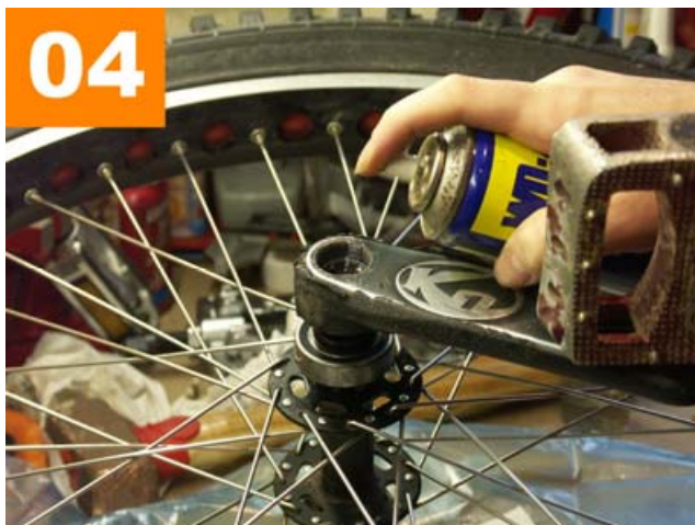
Image 4 Un peu de dégrissant facilitera l'extraction de la manivelle, surtout si celle-ci n'a jamais été démontée. Laissez agir 10 min avant de continuer.
