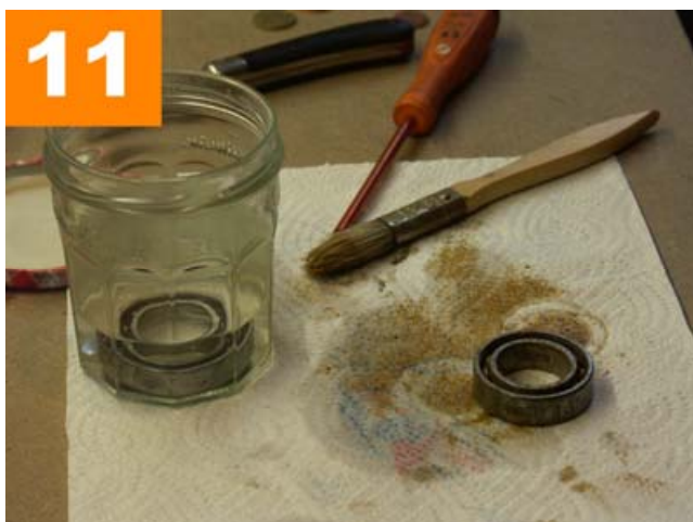
Image 11 Faites tremper vos roulements une nuit dans le pot de dégraissant. S'ils sont toujours grippés, changez-les pour des neufs.
