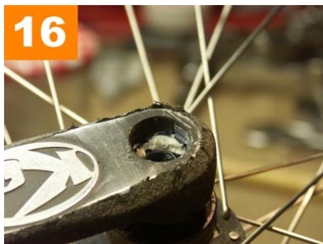
Image 16 Mettez de la graisse sur l'axe avant de monter la manivelle.
