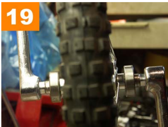
Image 19 Veillez à ce que les 2 manivelles soient enfoncées à fond. Un déséquilibre se ferait sentir en pédalant. Et un mauvais serrage userait vos manivelles très rapidement !
