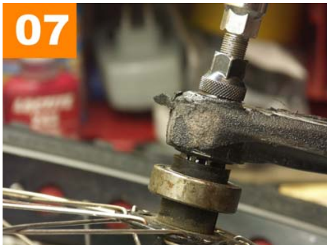
Image 7 Vissez la partie mobile jusqu'à décrocher la manivelle de l'axe. Tapotez sur les côtés (ici sur le grip) avec un maillet pour aider à sortir.
