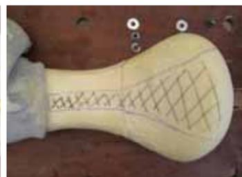
Tracer de petits repères sur la mousse pour ensuite délimiter la zone à découper : avec la règle qui va de la vis arrière gauche du pare-choc à la vis avant droite du tube de selle.
