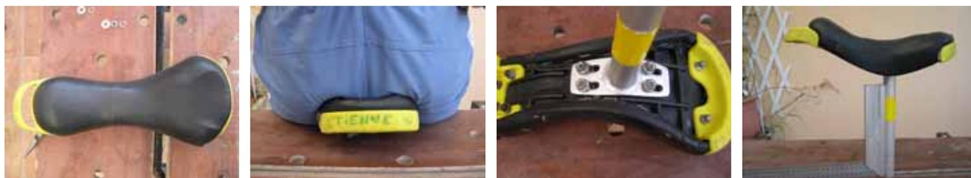
Vues de la selle taillée, on voit bien que l'appui se fait maintenant sur les ischions (os du bassin sous les fesses et entre les jambes), et que le coccyx est « dans le vide ».
