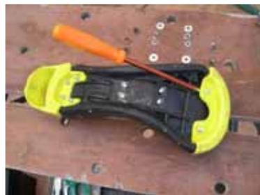
Vue des fixations : pare-choc avant (4 écrous borgnes + rondelles), tube de selle (4 écrous + rondelles), pare-choc arrière (2 écrous borgnes + rondelles).
